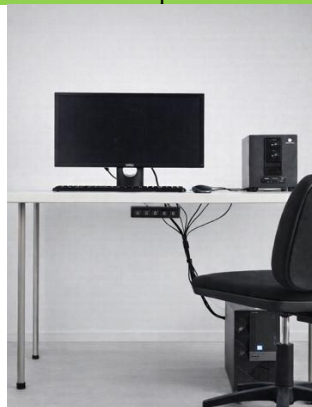
Sakārtoti un pārdomāti izvietoti datortehnikas vadi novērš iespēju aizķerties un pakļupt pret tiem
