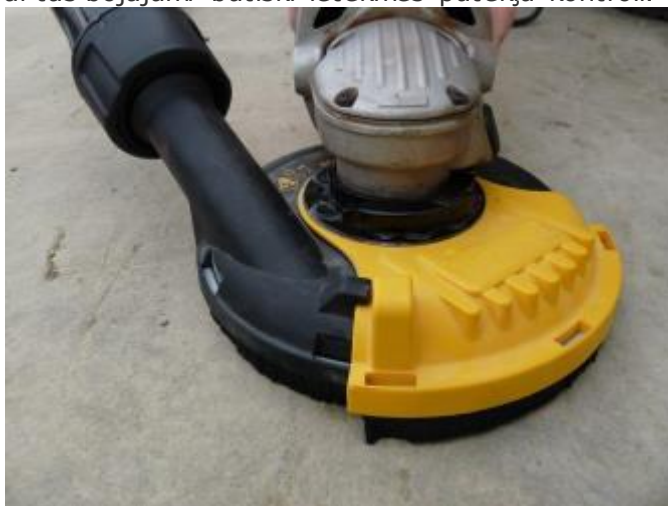
3. attēls. Smalcināšanas ierīce ar atsūknēšanu no instrumenta (avots: HSE, Lielbritānija).
