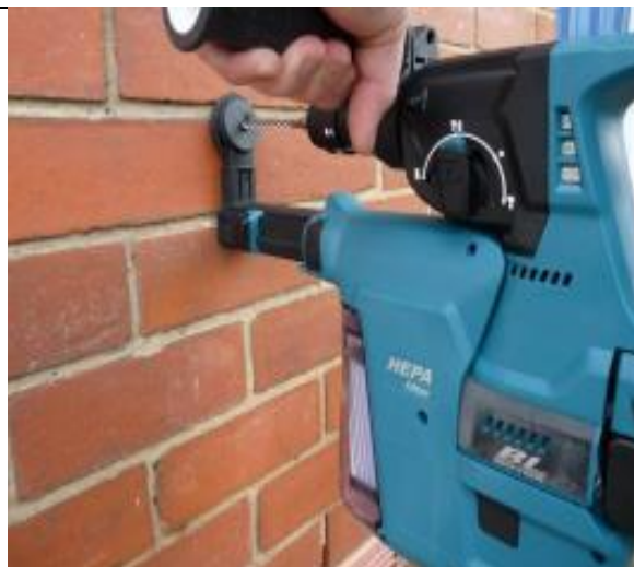
Labā prakse — rokā turama drupinātāja izmantošana, kuram ir integrēta kasete (HSE, Lielbritānija)
