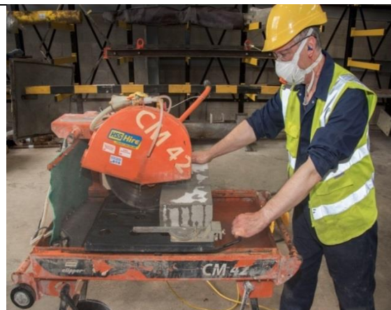
Labā prakse — tiek izmantota slapšana ar ūdeni (kā parādīts attēlā), operators lieto EAL ( HSE, Lielbritānija )
