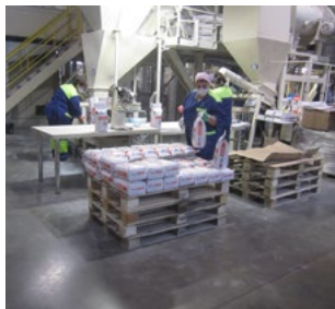
Palešu izmantošana, lai panāktu ergonomiski piemērotāku augstumu produkcijas nokraušanai, samazina slodzi mugurkaulam
