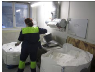
Lokālās atsūces ierīkošana materiālu sajaukšanas procesā ievērojami samazina putekļu nokļūšanu gaisā
