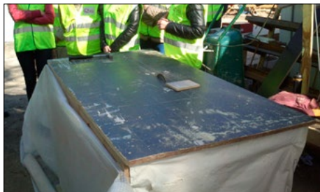
Pašdarināta darba aprīkojuma bez atbilstošas drošības sistēmas un aizsegumiem lietošana var beigties ar ļoti smagiem nelaimes gadījumiem
