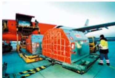
ULD tipa konteineru automatizēta iekraušana lidmašīnā
