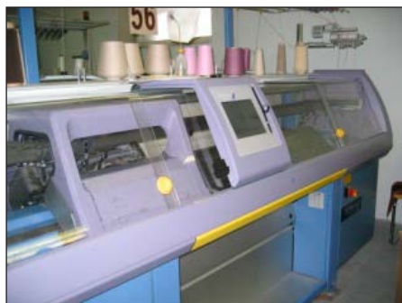
Aušanas iekārtas radītā trokšņa samazināšana ar troksni slāpējošu iekārtu vāku palīdzību
