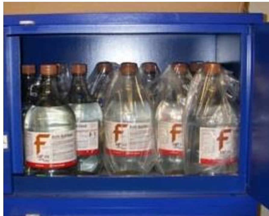
Pareiza korozīvu vielu (skābju un bāzu) uzglabāšana
