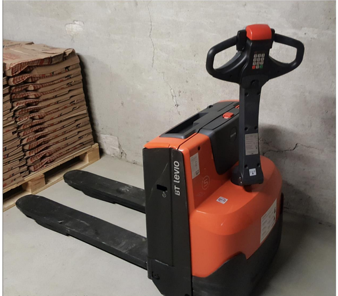
Elektriskie palešu ratiņi – aizvieto ar roku stumjamos, samazināta fiziskā slodze darbiniekiem.
