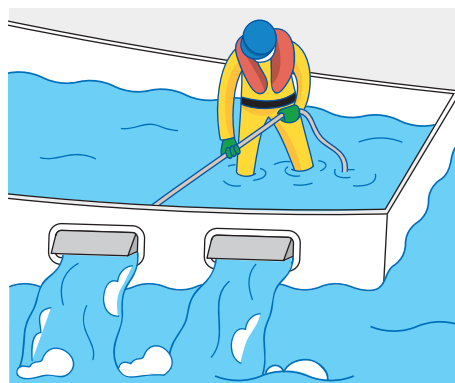
VI-7. Ūdens uz klāja plūst, radot brīvās virsmas efektu (pielāgotā veidā pārņemts no Transport Canada , 2003. gada marts)
