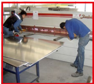
Detaļu apstrāde uz nepiemērota augstuma darbgaldiem piespiedu pozā var atstāt nelabvēlīgas sekas uz veselību
