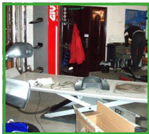
Galdu vai platformu ar viegli maināmu augstumu izmantošana būtiski samazina piespiedu pozu radītos riskus un darba slodzi
