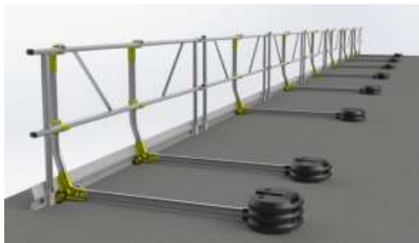
Pagaidu nožogojums AluFix® EVO. Augšējās margas augša ir 100,5 cm augstumā, Distance starp augšējo un vidējo margu ir 46,5 cm, kājlīstes augstums ir 15,7cm (kājlīste nav jāliek, ja jumta (platformas virsmai ir vismaz 15 cm augsta attika. Nožogojums atbilst standarta LVS 13374 prasībām.
