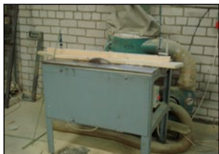
Pašdarinātas zāģēšanas iekārtas lietošana bez drošības aprīkojuma var novest pie pirkstu vai roku nozāģēšanas
