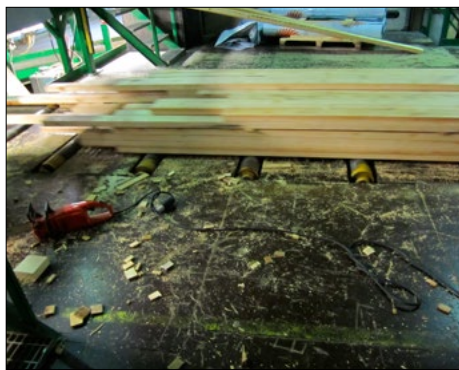
Nesakārtota darba vide – nevietā atstāti motorzāģi un nesavākti koka atgriezumī – var izraisīt smagus kritienus
