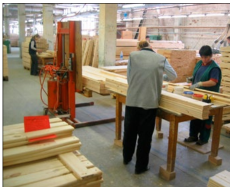
Darbagalda augstuma piemērošana nodarbinātajiem un automātiskā augstuma palešu ratiņu izmantošana būtiski samazina smagumu pārvietošanas un ergonomikas riskus
