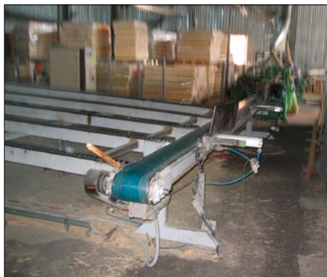
Ja netiek norobežotas kokmateriālu pārvietošanas līnijas vai šie norobežojumi netiek ievēroti, nodarbinātie strādā vai pārvietojas bīstami tuvu iekārtai
