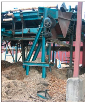
Nenostiprinot iekārtu drošības vākus tiem paredzētajā vietā, var rasties smagi nelaimes gadījumi
