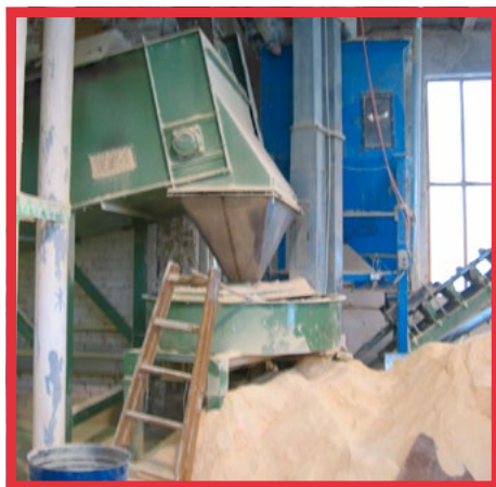
Savlaicīga putekļu nesavākšana un atsūces ventilācijas trūkums rada ļoti augstu putekļu koncentrāciju darba vides gaisā
