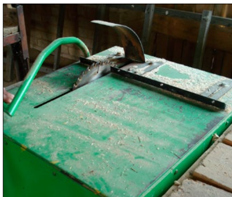
Pašdarinātu aizsargierīču lietošana negarantē nodarbināto aizsardzību pret nelaimes gadījumiem
