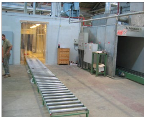
Vienkāršs ruļļu konveijers materiālu pārvietošanai ir salīdzinoši lēts un efektīvs smagumu pārvietošanas palīgīdzeklis
