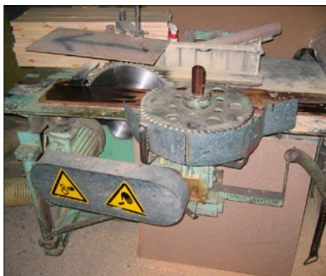
Darbs ar iekārtām bez drošības aprīkojuma vai ar pašdarinātu drošības aprīkojumu var veicināt nelaimes gadījumu risku
