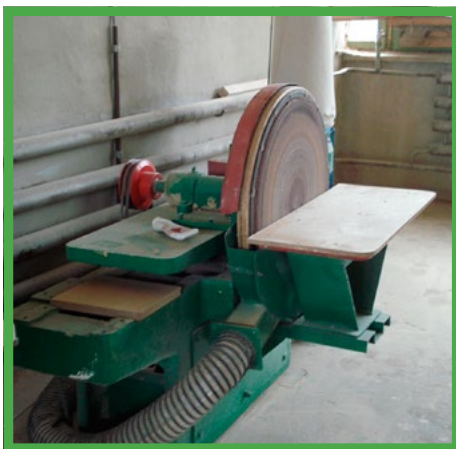
Iekārtu aprikošana ar atsūces ventilāciju un tās uzturēšana kārtībā nodarbinātajiem ievērojami samazina putekļu ekspozīcijas līmeni
