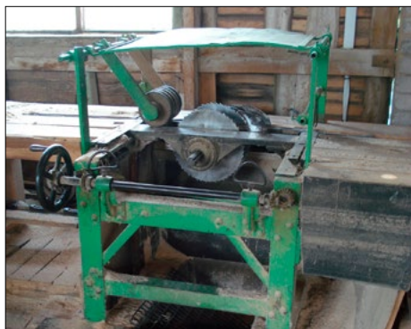
Pašdarinātu aizsargierīču lietošana negarantē nodarbināto aizsardzību pret nelaimes gadījumiem
