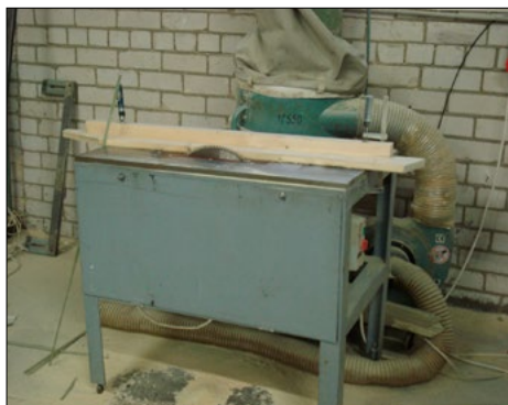
Pašdarinātas zāģēšanas iekārtas bez drošības aprīkojuma strādājot var būt bīstamas nodarbinātajiem
