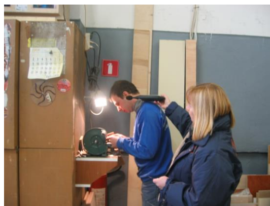
Attēls. Trokšņa mērīšana slīpētāja darba vietā
