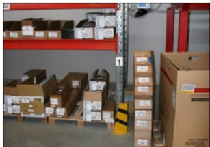
Noliktavas plauktu drošības norobežojumu lieto, lai novērstu iekrāvēju uzbraukšanas risku
