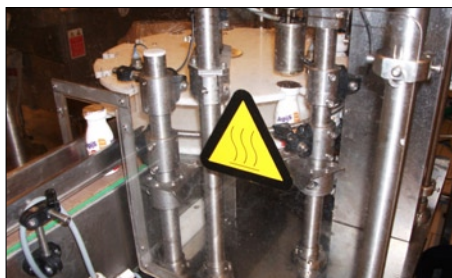
Ražošanas līniju karsto virsmu norobežošanas un apzīmēšanas ievērojami samazina nelaimes gadījumu risku
