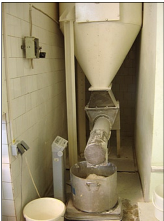
Miltu dozēšanas un bēšanas laikā rodas augsta potenciāli sprādzienbīstamu putekļu koncentrācija
