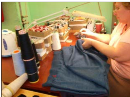
Regulējams vietējais apgaismojums var nodrošināt pietiekamu apgaismojuma līmeni tieši darba vietās
