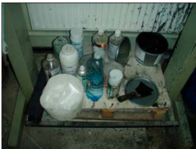
Ķīmisko vielu nepareiza un nedroša glabāšana (ķīmiskās vielas tiek glabātas nepiemērotos traukos, bez uzrakstiem un marķējumiem)
