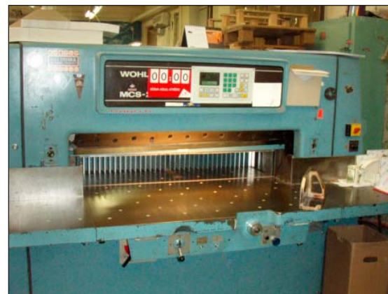
Darbā ar dažādām iekārtām (griešanas iekārtām, nažiem) ir raksturīgs augsts nelaimes gadījumu risks; šis darbagalds ir aprīkots ar drošības slēdzi
