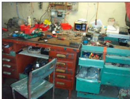
Nedroša un nekārtīga rokas instrumentu glabāšana rada nelaimes gadījumu risku un samazina darba produktivitāti
