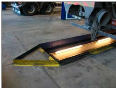
Bīstamās vietas (piemēram, remonta bedres malas) jāapzīmē ar signālkrāsojumu
