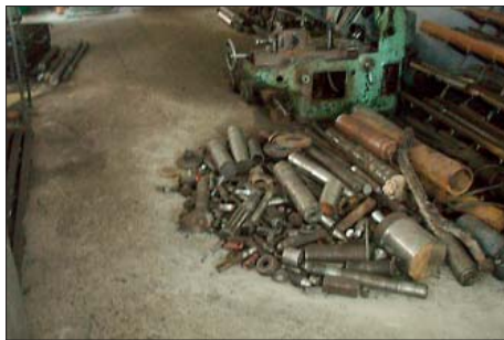
Dažādu remontam nepieciešamo detaļu izvietošana pārvietošanās ceļā rada paklupšanas risku
