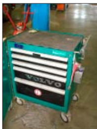
Rokas instrumenti jāglabā speciālās kastēs, stendos vai instrumentu skapjos
