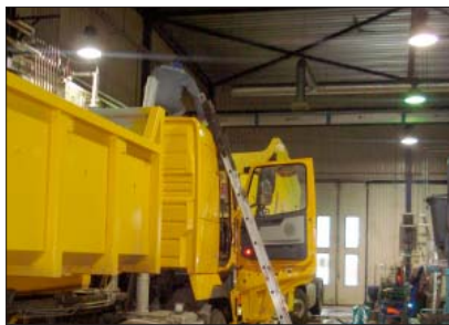
Strādājot uz kabīnes jumta vai izmantojot nedrošas pārvietojamās kāpnes, nevar izslēgt smagu kritienu risku
