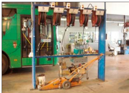
Dažādu tehnisko šķidrumu sadales sistēma, kas novērš nepieciešamību glabāt šķidrumus nepiemērotos traukos
