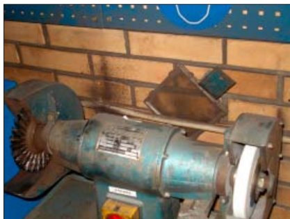
Drošības prasībām neatbilstoša slīpripa ar demontētu drošības vairogu ir bīstama
