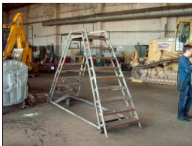
Nedrošs aprīkojums (kad nav nodrošinātas margas un iespēja nekustīgi nostiprināt riteņus) rada augstu nelaimes gadījumu risku
