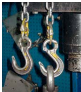
Kravu pārvietošanai lietoto ķēžu āķiem jābūt tehniskā kārtībā, lai krava nenokristu
