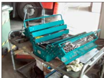
Rokas instrumenti jāglabā speciālās kastēs, stendos vai instrumentu skapjos
