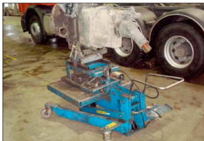
Pacēlājs smagu detaļu pārvietošanai un novietošanai remontam vai montāžai ērtā augstumā
