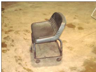
Pašdarināts ergonomisks palīglīdzeklis darbu veikšanai zemā sēdus stāvoklī, lai nebūtu jāstrādā tupot vai noliecoties
