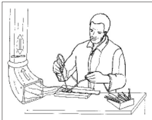
3.23. attēls. Pareizi iekārtota lodētāja darba vieta ar vietējo ventilāciju
